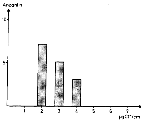
Tafel 4.2. Chloridbedeckung einer Zentraleinheit nach zwei Jahren Betrieb (metallische Oberflächen).
