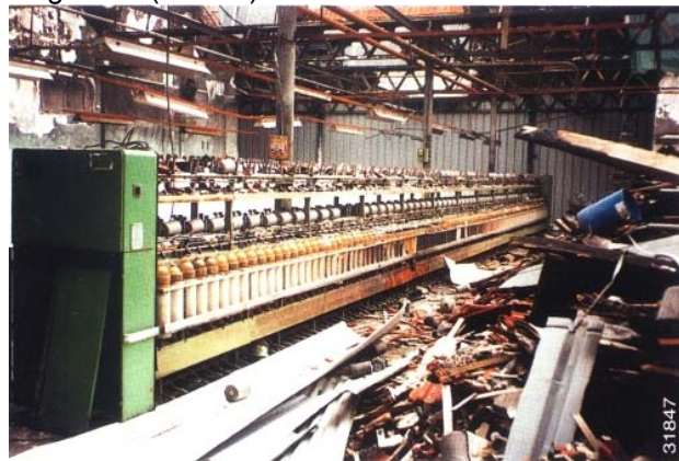
Bild 11 Beispiel einer thermisch geschädigten Textilmaschine
