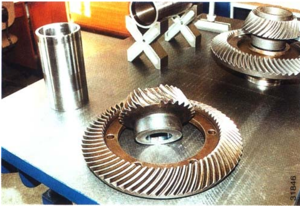
Bild 10 Teller- und Kegelrad des Winkelgetriebes von Bild 9 mit Ausbrüchen der Bogenverzahnung - dahinter neu konstruiertes Zahnradpaar mit geänderter Lauffrichtung
