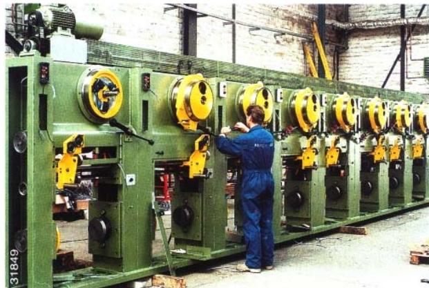
Bild 13 Drahtrollwickelmaschinen von Bild 12 nach der Sanierung und Remontage
