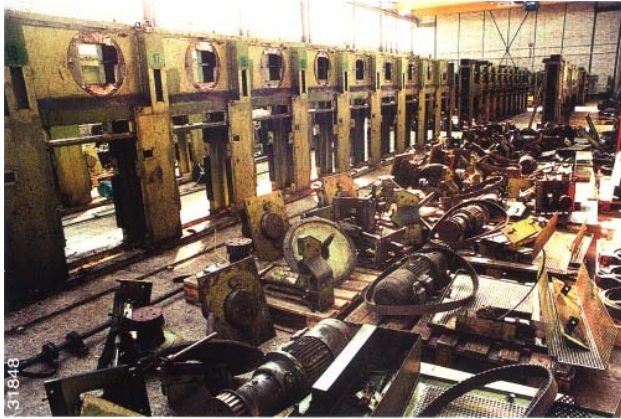
Bild 12 Beschädigte Drahtrollwickelmaschinen nach der Demontage (vgl. Bild 13)
