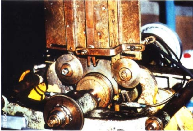
Bild 14 Beschädigte Maschine zur Herstellung von Weißblechdosen (vgl. Bild 15)
