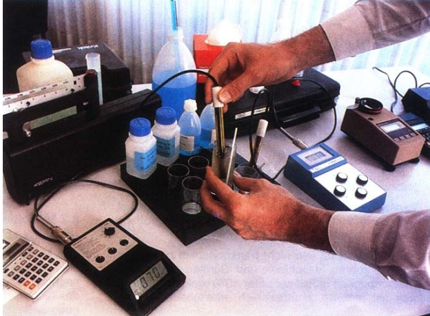
Quantitative Analyse mit der mobil einsetzbaren Chloridelektrode (Im Bild werden zwei unterschiedliche Ausrüstungen gezeigt)
